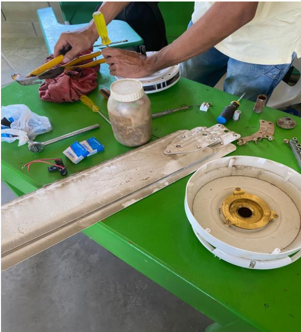
Mantenimiento, cambio de capacitores, balineras y embobinadas (94 Ventiladores)
