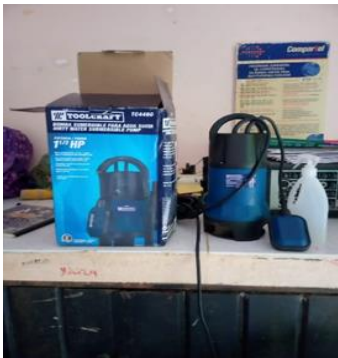
Electrobomba suemergible de 1.5 hp para aljibe sede Villa Esther
